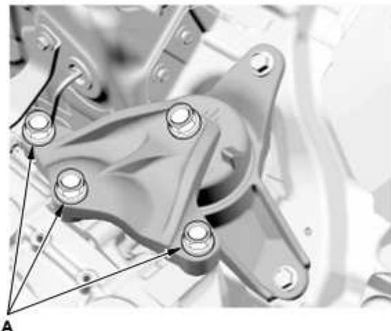
14. 所有发动机支座安装螺栓和螺母 - 拧紧
