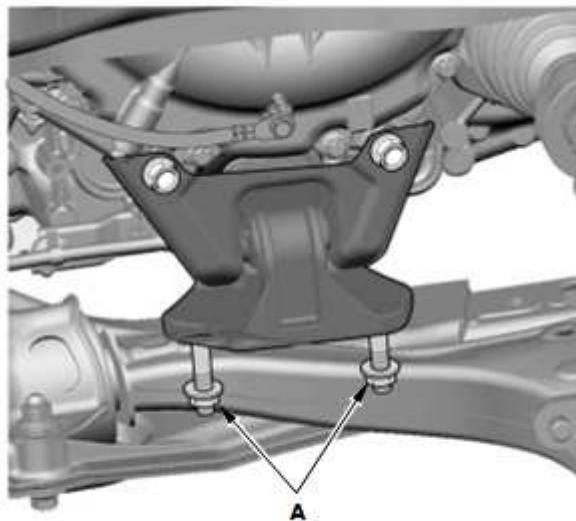
7. 发动机后支座托架安装螺栓 - 松开
