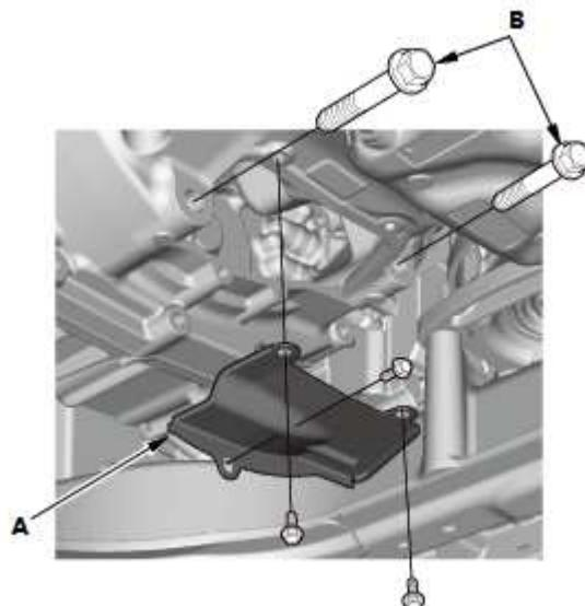
3. 拆下油底壳安装螺栓。
