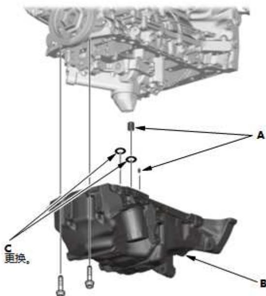
4. 分三步拧紧螺栓；拧紧螺栓直至螺栓固定在油底壳上，拧紧螺栓直至衬垫已压紧，拧紧螺栓至规定扭矩。
