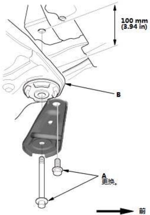
2. 在前侧从前副车架 (B) 上拆下安装螺栓 (A)。
